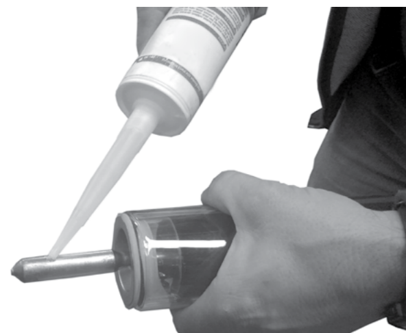
Adăugați rășina termoconductoare pe condensatorul țevii heat-pipe.
