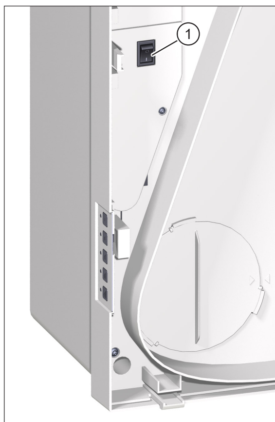
Fig. 13: Comutator de rețea, vizibil atunci când se scoate capacul aparatului
