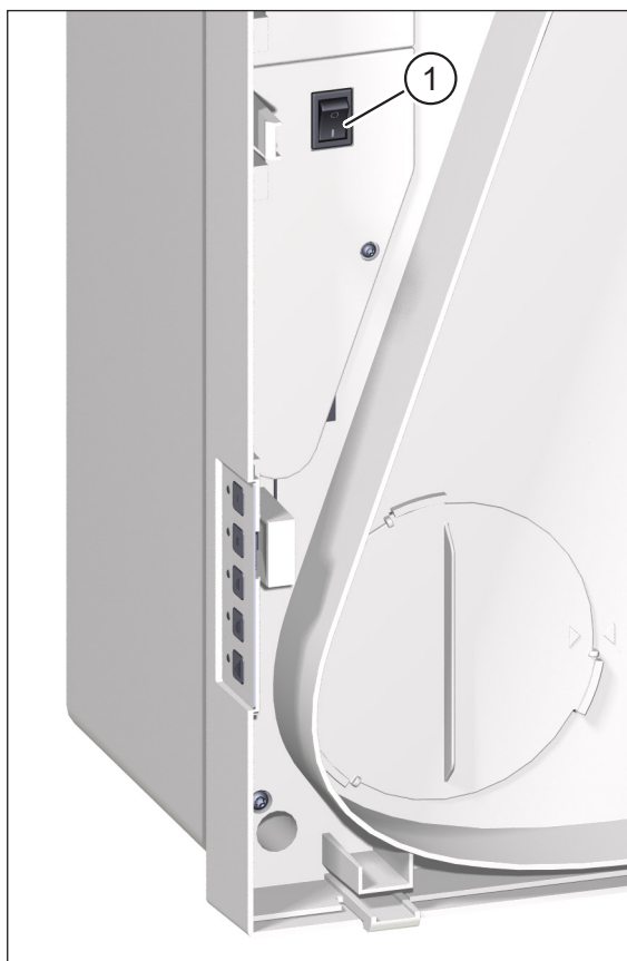
Fig. 14: Comutator de rețea, vizibil atunci când se scoate capacul aparatului
